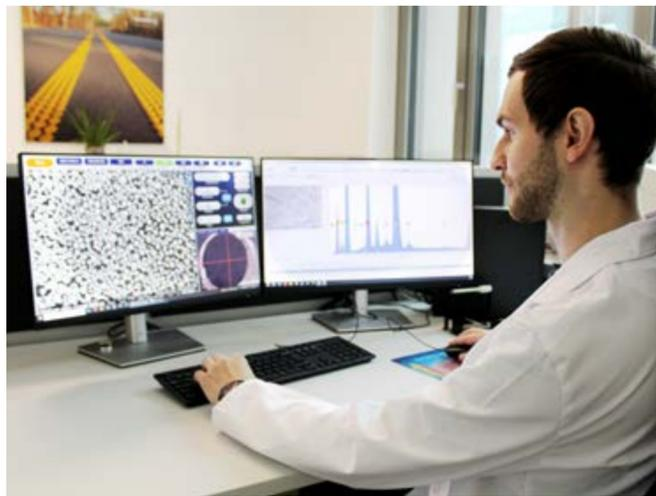
Matthias Fussthaler prüft die Spezifikationen der Glasperlen mittels einem Rasterelektronenmikroskop.
